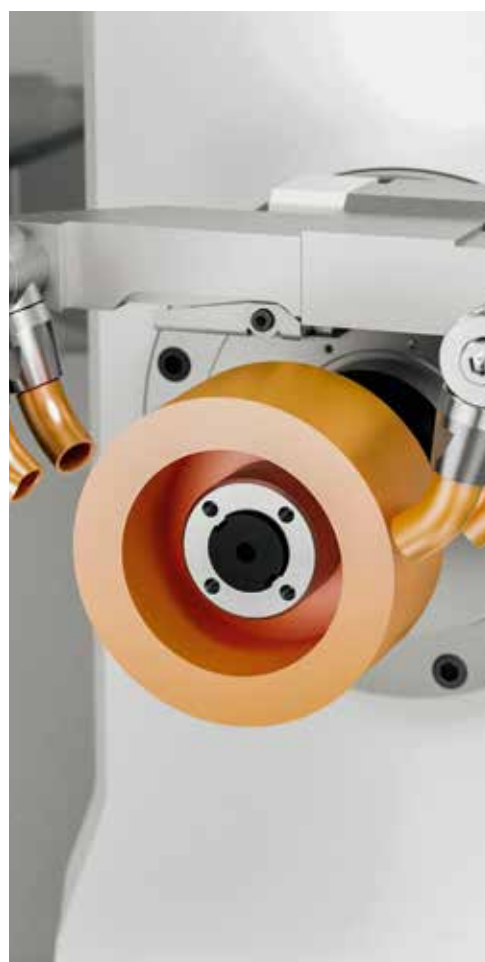
////// UNIDADE DE ELETROEROSÃO
