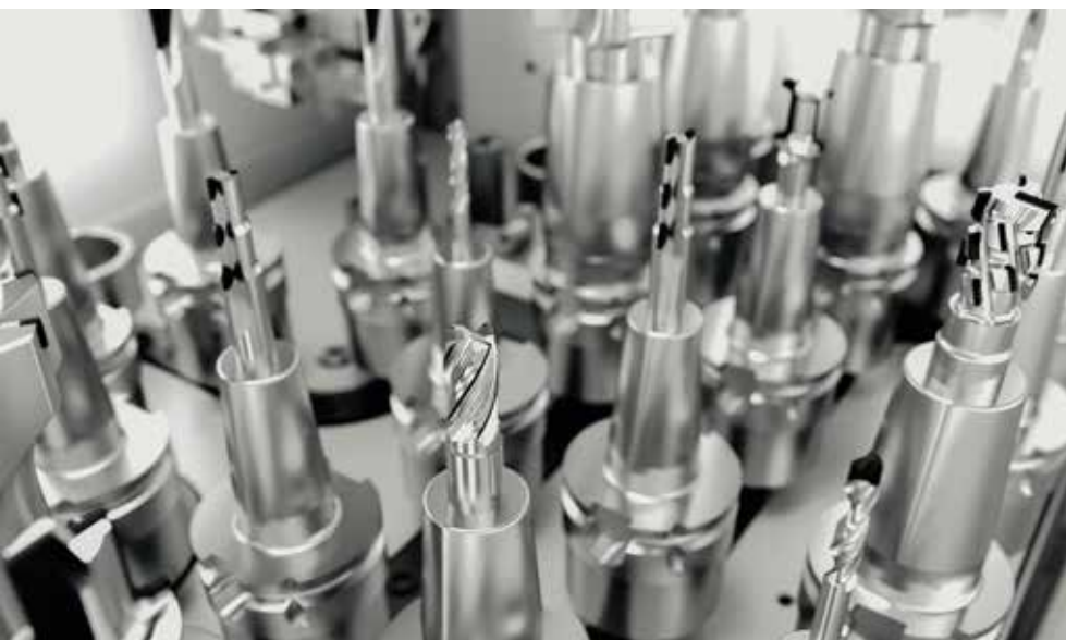
////// MAGAZYN ŁAŃCUCHOWY HC 4 ORAZ HC 4 plus w budowie kompaktowej
