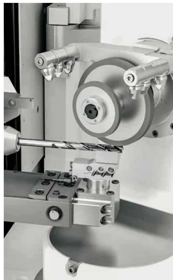
////// LUNETAS CON ELEVACIÓN AUTOMÁTICA para un resultado óptimo del afilado con herramientas largas
