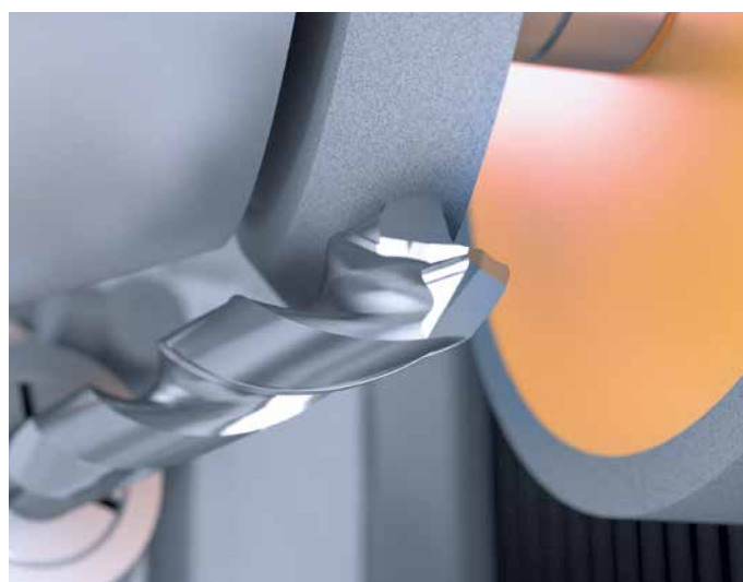
/// ОБРАБОТКА ТВЕРДОСПЛАВНЫХ СВЕРЛ
