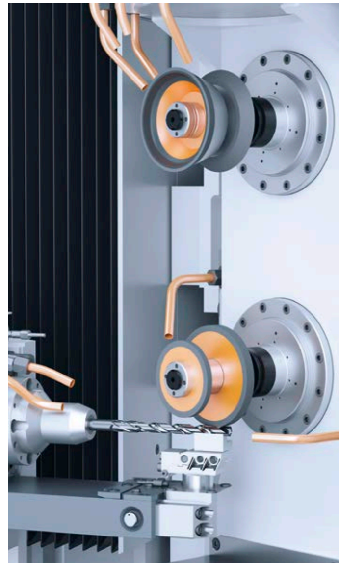
/// 支撑托架： 保证刀具磨削时避免出现弹性让刀
