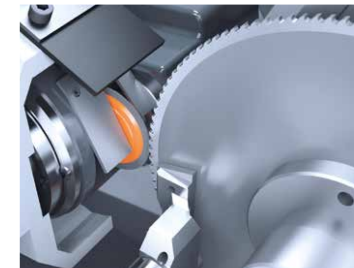
/// SPANTEILERBEARBEITUNG AN HSS-SÄGEN mit 50 mm Schleifscheibe
