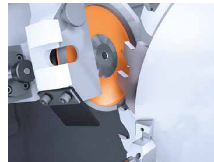
/// FREIFLÄCHENBEARBEITUNG an Spanersegment aus der Sägewerksindustrie
