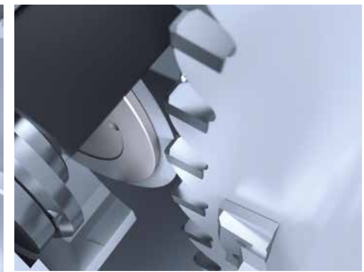
/// SPANTEILERBEARBEITUNG mit 125 mm Schleifscheibe
